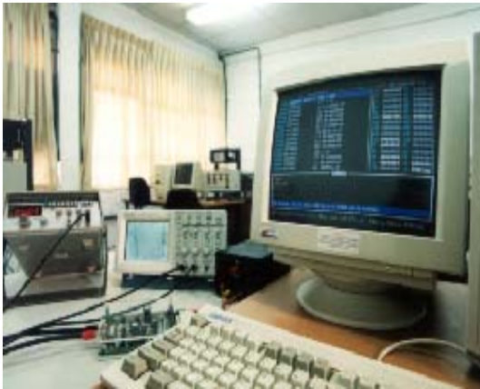
FIGURE. 4 BASIC SYSTEM WITH DSP TMS320C31, MICROCOMPUTADOR, GERADOR DE SINAIS E OSCILÓSCÓPIO
